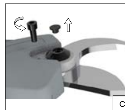
C. Retirez la vis M5 en la tournant dans le sens inverse des aiguilles d'une montre comme indiqué sur la figure, retirez également le couvercle en caoutchouc.
